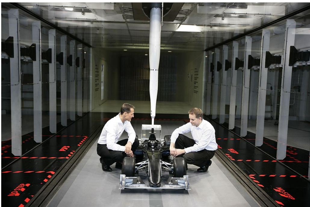
Obr. č. 19 Zmenšený model formule na testování
