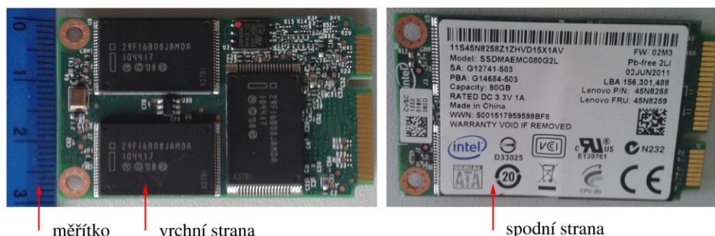
Obr. č. 6: SSD pevný disk s kapacitou 80 GB
