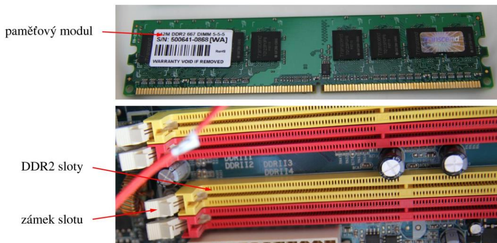
Obr. č. 5: Paměťový modul DDR2 a jemu odpovídající čtyři sloty na základní desce
